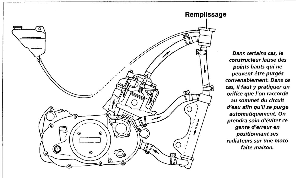
*Dans certains cas, le constructeur laisse des points hauts qui ne peuvent être purgés convenablement. Dans ce cas, il faut y pratiquer un orifice que l'on raccorde au sommet du circuit d'eau afin qu'il se purge automatiquement. On prendra soin d'éviter ce genre d'erreur en positionnant ses radiateurs sur une moto faite maison.*
