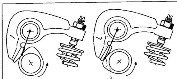
*Déplacement des points de contact. La position relative des différents éléments de la distribution évolue au fur et à mesure de la levée de soupape. Cette variation entraîne un changement de rapport de levée du basculeur qui doit être pris en compte lors du dessin de l'arbre à cames, afin d'obtenir une accélération correcte au niveau de la soupape.*
