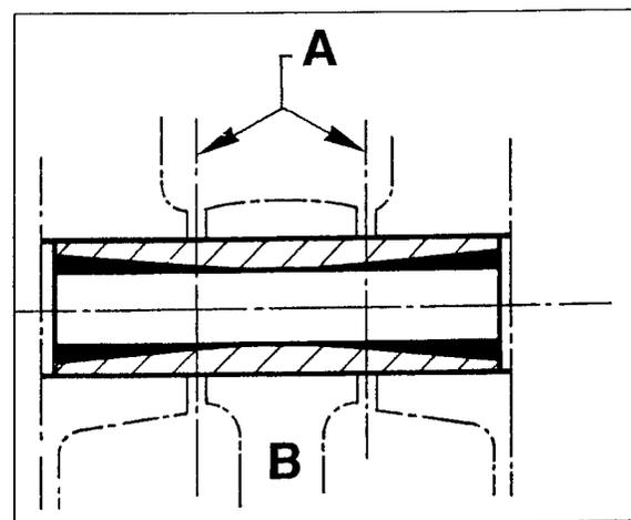
*Usinage d'un axe de piston conique. L'évidement des extrémités des axes de piston permet de réduire la masse, mais, en endurance, on évitera de prendre ce genre de risque.*
