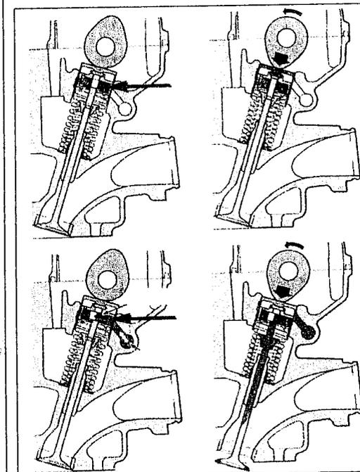
*Vue du principe de fonctionnement de la CB 400 Honda VTEC. À bas régime, le poussoir agit "dans le vide". Il ne comprime qu'un ressort extérieur qui lui est propre la soupape ne se soulève pas. À haut régime, un jet d'huile vient pousser une entretoise qui permet au godet de commander directement la soupape. Le moteur change alors de registre et le docile huit-soupapes se transforme alors en un seize-soupapes turbulent (Source Moto Journal).*
