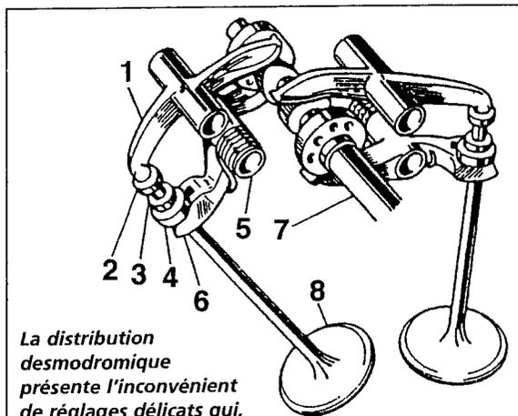
*La distribution desmodromique présente l'inconvénient de réglages délicats qui, s'ils ne sont pas corrects, peuvent provoquer des efforts importants au niveau des queues de soupape, allant jusqu'à la rupture d'une pièce.*
