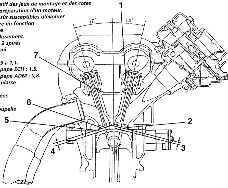
Si l'on déplace la portée le plus possible à l'extérieur de la soupape, on peut obtenir un diamètre théorique de passage de :
