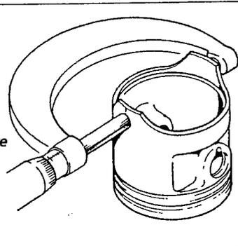
ensuite prendre la cote exacte du piston pour usiner la chemise après emboîtement, en y laissant juste le jeu de fonctionnement nécessaire. L'état de surface doit bien sûr être parfait, c'est-à-dire présenter une rugosité suffisante pour une bonne lubrification. Un rodoir avec un grain de 400 constitue une valeur correcte.
