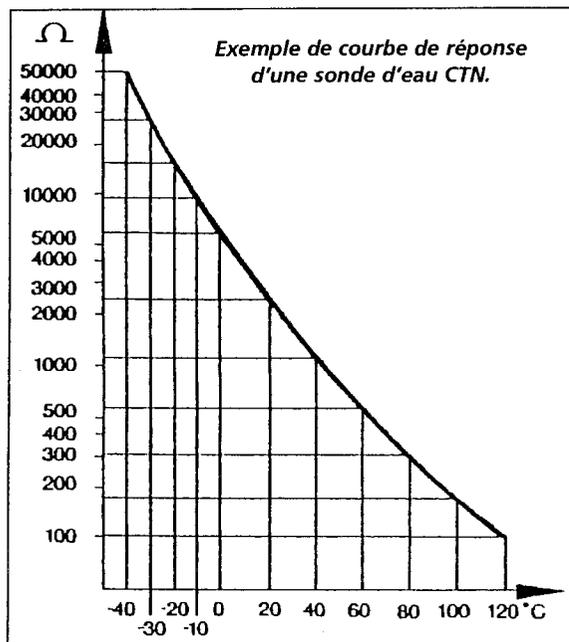
Montée sur le circuit de refroidissement du moteur, cette sonde informe le calculateur essence de la température d'eau. Elle peut être du type CTN soit coefficient de température négatif, c'est-à-dire que sa résistance diminue quand la température augmente, ou au contraire CTP, coefficient de température positif.
