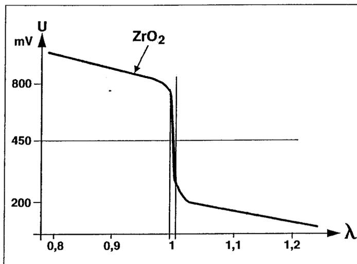
*Courbe de réponse d'une sonde lambda. Le signal de la sonde varie entre 0 et 1 V autour d'une richesse "idéale" de 1. Dès que l'on s'écarte de cette valeur, le signal ne varie quasiment plus. On peut donc facilement déterminer si le mélange est riche ou pauvre, mais on ignore la valeur exacte du rapport lambda.*
