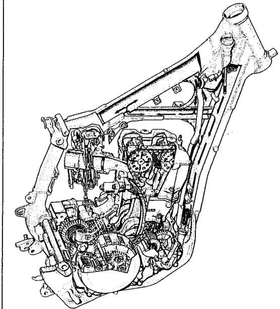
*Lubrification et refroidissement sont indissociables. Sur le moteur de cette Suzuki DRZ400-E, l'huile circule dans le cadre (carter sec) ce qui lui permet de se refroidir tout en diminuant la hauteur du carter moteur.*
