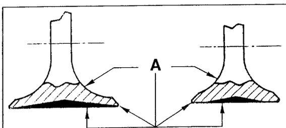
*L'allègement des soupapes est parfois possible. À l'admission, on pourra décoller la partie de la tige qui dépasse du guide et creuser la tulipe afin de l'aplatir, ce qui semble conjuguer réduction de masse et amélioration du débit. À l'échappement, on pourra légèrement creuser le dessous de la tulipe et polir l'ensemble ce qui permet quelques gains et réduit l'accrochage de la calamine (qui peut alourdir la soupape).*
