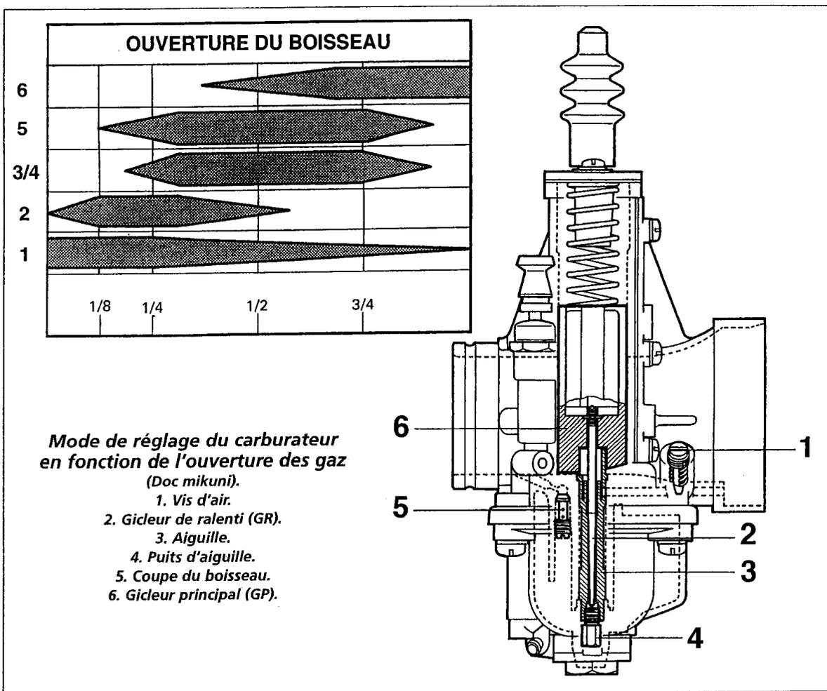
**Mode de réglage du carburateur en fonction de l'ouverture des gaz**
