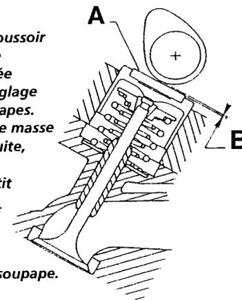
*Plus la vitesse de levée est importante, c'est-à-dire plus l'AAC est efficace plus le point de contact came/poussoir est excentré par rapport à la soupape, ce qui impose un poussoir de fort diamètre donc plus lourd. Cette contrainte limite les performances des godets.*
