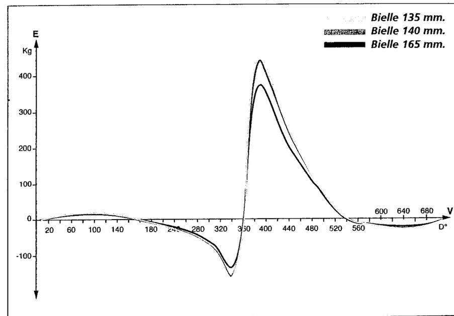
Influence de la longueur de bielle sur la réaction de frottement piston/cylindre.
