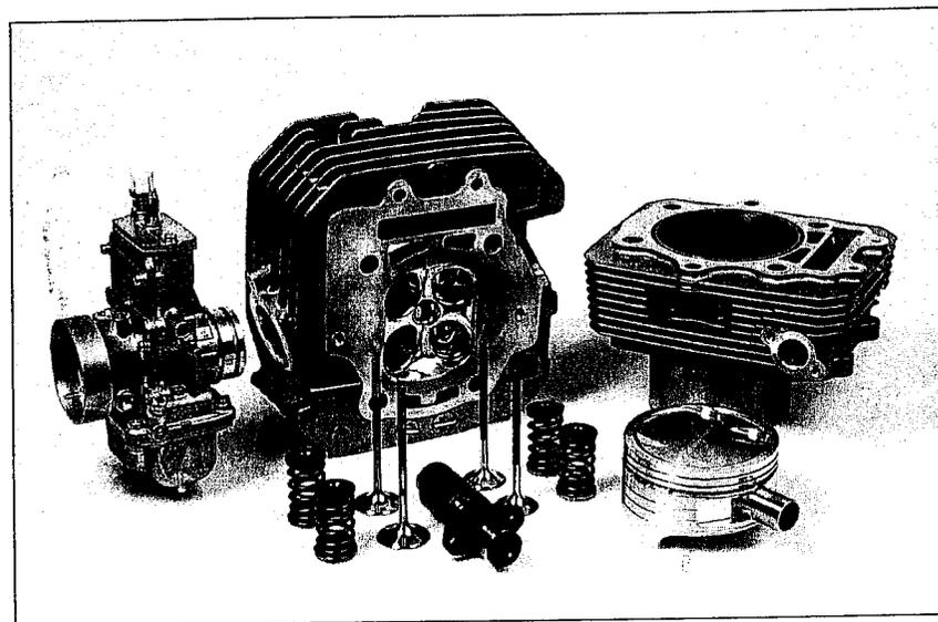
*L'augmentation de cylindrée est une façon relativement simple de gagner du couple et des chevaux, surtout sur un mono. Ici, un 441 cm<sup>3</sup> (42 ch) développé par J.-L. Bazin sur base DR 350. Sur un multicylindre, l'opération s'avère très coûteuse et parfois plus difficilement réalisable, en raison du manque d'espace disponible entre les différents fûts. (Source Moto Journal).*
