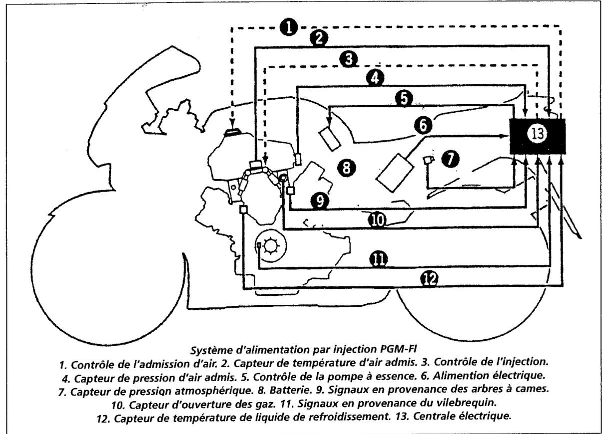
retour. Là encore, dans un souci d'économie, on pourra utiliser des accessoires issus de voitures courantes, facilement disponibles d'occasion. De même, les injecteurs seront choisis sur un moteur développant une puissance unitaire (c'est-à-dire cylindre par cylindre) assez proche. À défaut, on pourra faire appel à deux injecteurs par cylindre pour rester dans des temps d'injection raisonnables.
