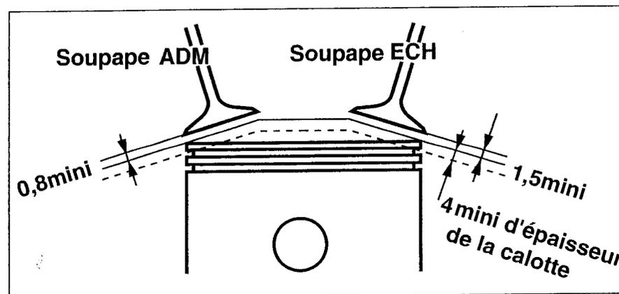
tiquer des encoches fraisées dans la calotte. Là aussi, vérifiez bien l'épaisseur du ciel de piston qui ne doit pas être inférieure à 4 mm en règle générale.
