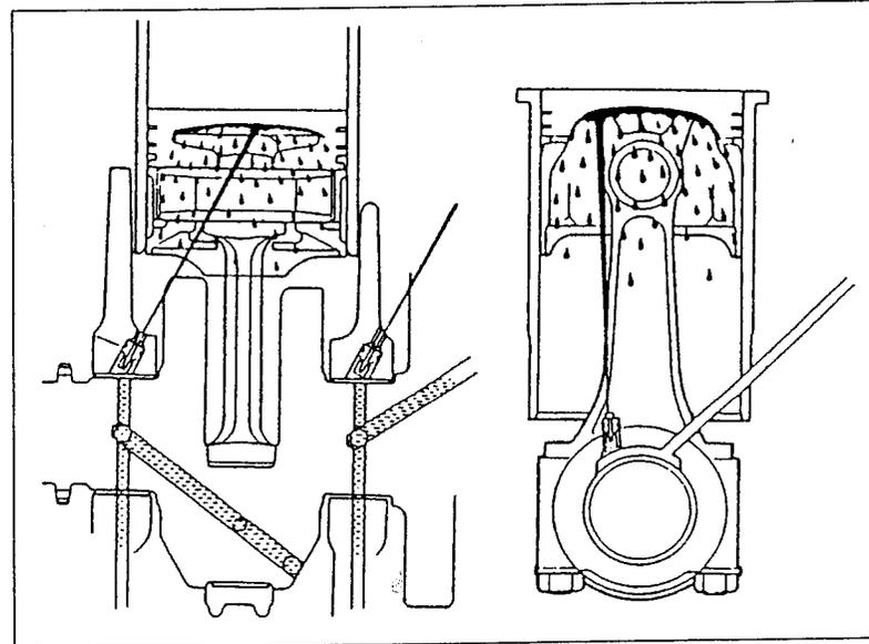
*L'avantage des segments fins réside dans la forte pression spécifique qu'ils exercent pour un effort de tension malgré tout faible. Ils combinent donc une étanchéité convenable et de faibles pertes par friction. Revers de la médaille : une usure plus rapide et une plus forte sensibilité à l'échauffement.*
