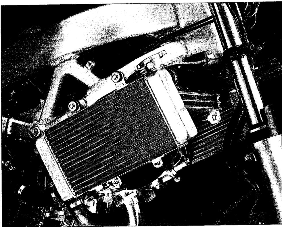
*Sur les machines sportives, le positionnement des radiateurs est un casse-tête pour les constructeurs. Honda a opté pour une solution latérale afin de réduire l'empattement de son twin sportif.*
