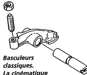
*Basculeurs classiques. La cinématique des basculeurs à patins courbes est particulièrement délicate à déterminer par calcul; pour l'amateur, le plus simple sera encore de raisonner par homothétie, c'est-à-dire en utilisant un coefficient multiplicateur (voir texte).*
