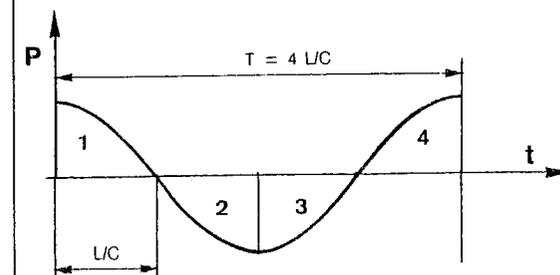
On peut voir ici le mode de résonance d'un conduit d'admission dont la soupape est fermée. Ce n'est qu'au bout de deux allers-retours que l'onde revient identique à elle-même. On dit alors que le conduit vibre en quart d'onde.
