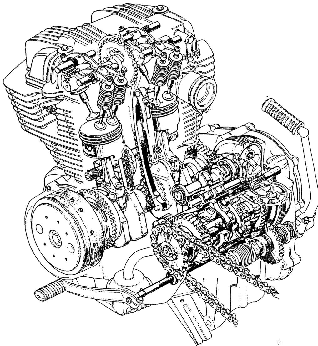
levées ou de la raideur des ressorts augmente sensiblement la résistance à la rotation de la distribution et les vibrations supportées par la transmission qui subit les tensions et détentions des ressorts.
