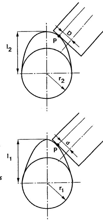
*L'implantation de cinq soupapes limite le diamètre maximum des godets et donc la vitesse de levée, en raison des contraintes mécaniques et thermiques de la culasse. C'est peut-être cette limitation qui pousse Yamaha à remettre en cause son concept 5 soupapes par cylindre.*
