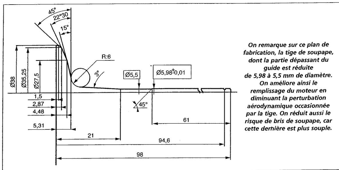
*On remarque sur ce plan de fabrication, la tige de soupape, dont la partie dépassant du guide est réduite de 5,98 à 5,5 mm de diamètre. On améliore ainsi le remplissage du moteur en diminuant la perturbation aérodynamique occasionnée par la tige. On réduit aussi le risque de bris de soupape, car cette dernière est plus souple.*
