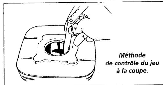
À noter d'ailleurs que c'est lors du montage du segment sur le piston que celui-ci subit la plus forte contrainte, à l'opposé de la coupe. On veillera donc à ne pas l'écarter inutilement pour ne pas dépasser sa limite élastique. L'idéal consiste à écarter les deux bords avec les pouces, puis à dégager la partie arrière du segment et à le faire pivoter.
