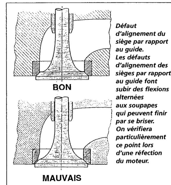
Il faut donc particulièrement surveiller ce point lors du remontage moteur. La qualité du contact siège/portée est fondamentale. Toutefois, on a constaté un abaissement du phénomène de bris de soupape en réduisant l'extrémité de la tige entre la surface en contact avec le guide et la tulipe. La diminution de section n'excédera pas 15 % de la surface totale en général, soit par exemple un décolletage à 5,5 mm sur une tige de 6 mm.
