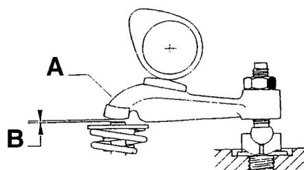
*L'interposition d'un linguet entre l'arbre à cames et la soupape permet de réduire l'inertie de la distribution par rapport à des godets, en particulier dans le cas de fortes vitesses de levée.*
