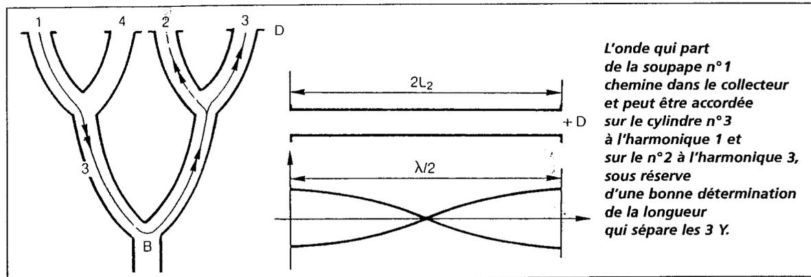
L'onde qui part de la soupape n°1 chemine dans le collecteur et peut être accordée sur le cylindre n°3 à l'harmonique 1 et sur le n°2 à l'harmonique 3, sous réserve d'une bonne détermination de la longueur qui sépare les 3 Y.
