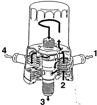
*Vue d'un filtre à huile avec circulation d'eau. Sur les moteurs modernes, on active la montée en température de l'huile en la mettant en contact avec l'eau au niveau du filtre. À chaud, c'est le contraire : l'eau refroidit le lubrifiant. Ainsi, la température de fonctionnement moteur est plus stable et son rendement s'en trouve amélioré.*
