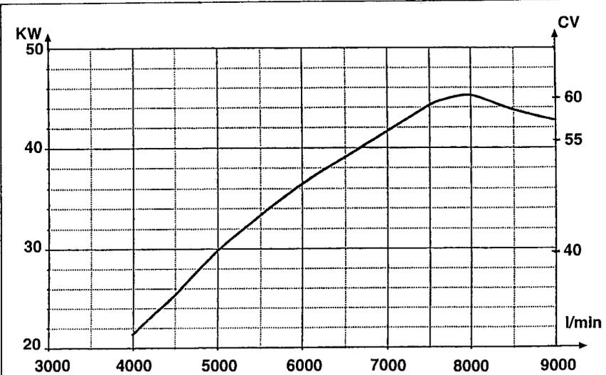
*Courbe de couple et de puissance d'un moteur Rotax 605 GS/A. Sur ce monocylindre, le couple maxi est atteint là où la puissance culmine chez les autres. Grâce à une conception d'ensemble optimisée pour une forte puissance, mais aussi à des mégaphones calculés en conséquence, la puissance ne chute que faiblement, même à 9000 tr/min. Soit une vitesse moyenne du piston de 24,3 m/s, ce qui est impressionnant pour un monocylindre de (petite) série.*
