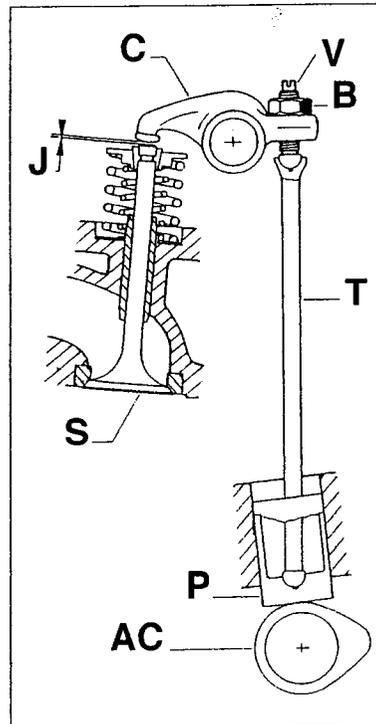
*Vue d'ensemble d'une distribution à arbre à cames latéral. On ne trouve plus ce genre de commande de la distribution que sur des mécaniques très rustiques.*
