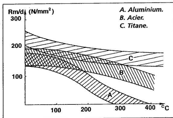
*Résistances spécifiques des aciers de construction et des alliages d'aluminium et de titane en fonction de leur température d'utilisation. Le titane semble convenir à de nombreux domaines d'application. Il présente toutefois deux défauts : son prix et sa mauvaise conductibilité thermique; c'est peut-être ce qui a limité son application dans les pistons, mais seuls ceux qui en feront l'essai le sauront !*
