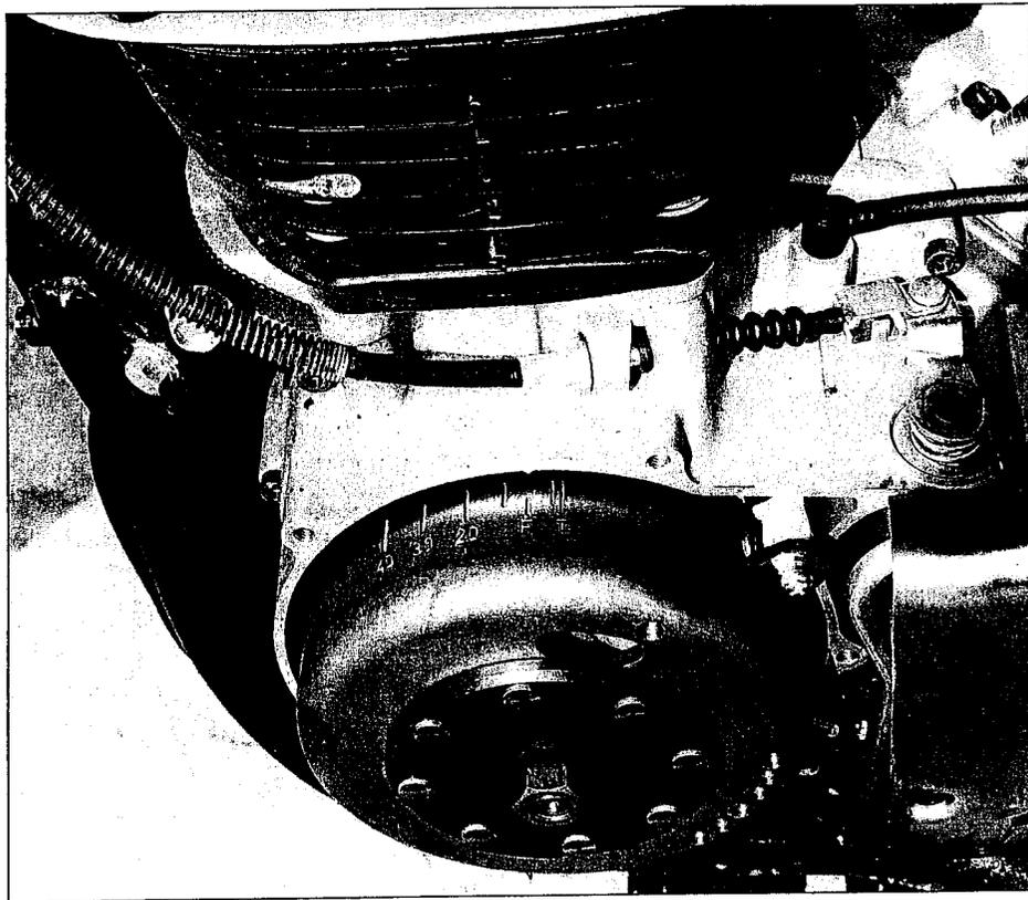
*Le volant moteur idéal doit combiner une faible masse, pour ne pas alourdir le moteur et une forte inertie pour emmagasiner l'énergie nécessaire à la compression du cycle suivant. On obtient ce résultat en disposant le maximum de masse à l'extérieur de la pièce, car l'inertie est proportionnelle à la masse et au carré du rayon.*
