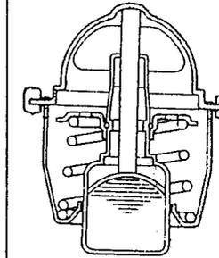
*Le calorstat est en place pour retarder la circulation d'eau du moteur tant qu'il est froid. En course, on le supprimera ce qui facilitera la circulation d'eau. En cas de froid, il faudra alors couvrir le radiateur pour retrouver une température de fonctionnement idéale, comprise en général entre 70° et 85°.*
