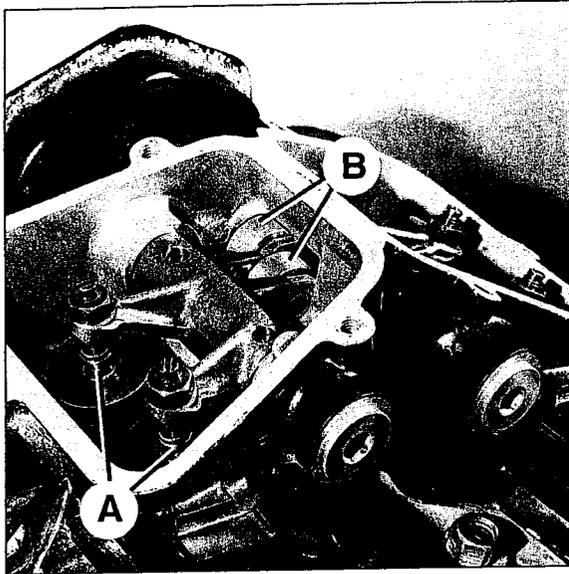
*L'utilisation de rouleaux sur les basculeurs permet de réduire les frottements et les risques de grippage des culbuteurs. Attention à surveiller l'état correct des aiguilles, qui peuvent occasionner de gros dégâts en cas de dislocation du roulement.*
