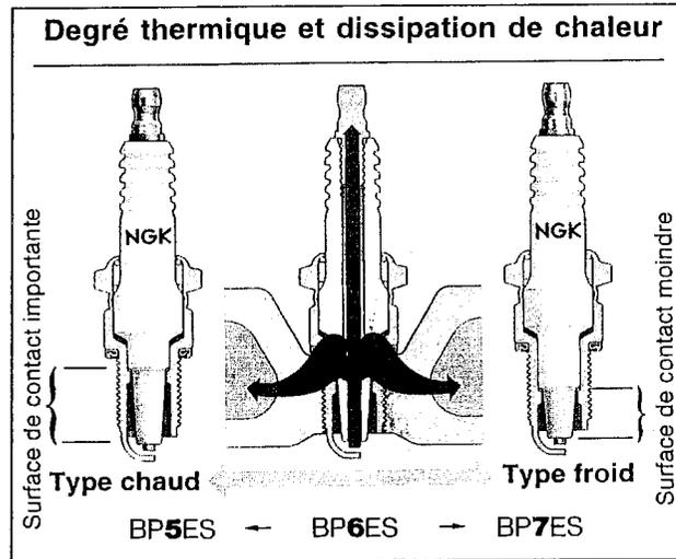
Plus la surface en contact avec la flamme est grande, plus la bougie est chaude. On risque alors une surchauffe du piston. Au contraire, si elle est trop froide, elle s'encrasse vite et la puissance chute (Document NGK).
