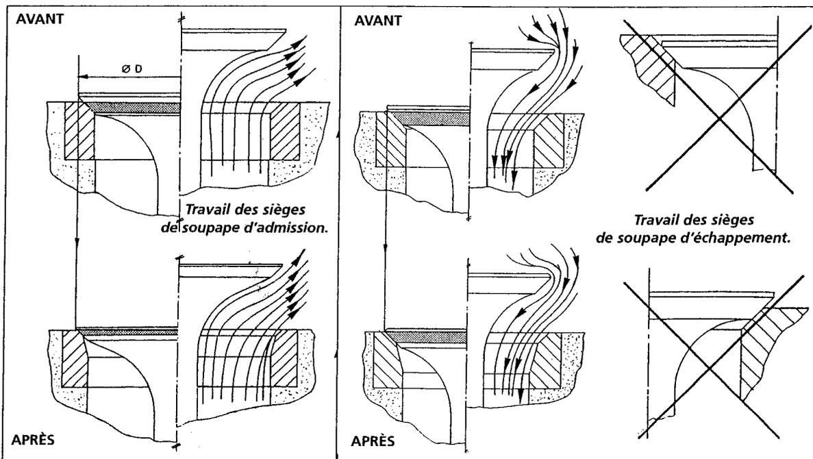
*Raccordement conduit/siège sur une 600 supersport. Sur cette culasse de 600 CBR Honda, il n'est pas utile d'augmenter les diamètres des conduits. Un simple alignement des sièges comme indiqué suffit à parfaire l'admission. La préparation d'un tel moteur n'est vraiment pas un travail pour débutant. On peut y faire beaucoup plus de mal que de bien (Document Honda).*
