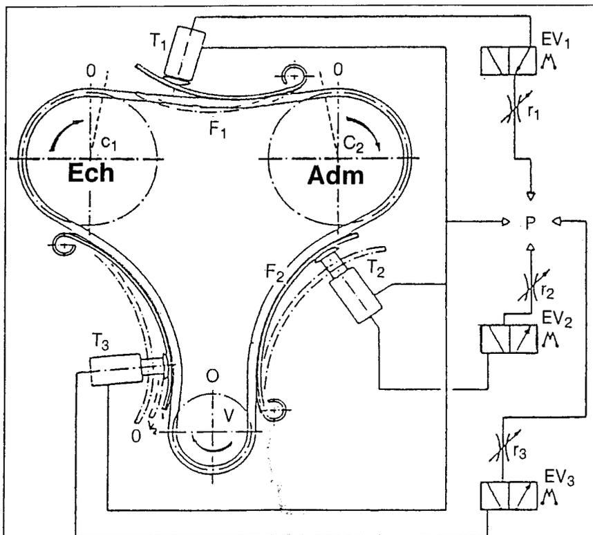
*Le calage de distribution variable est une solution intéressante pour étaler la plage d'utilisation d'un moteur. Il présente l'intérêt de ne pas alourdir les pièces en mouvement de pilonnage, ce qui ne réduit pas le potentiel de puissance maxi. La durée des ouvertures et les levées de soupape ne variant pas. L'impact est tout de même moins sensible que celui d'une véritable admission variable.*
