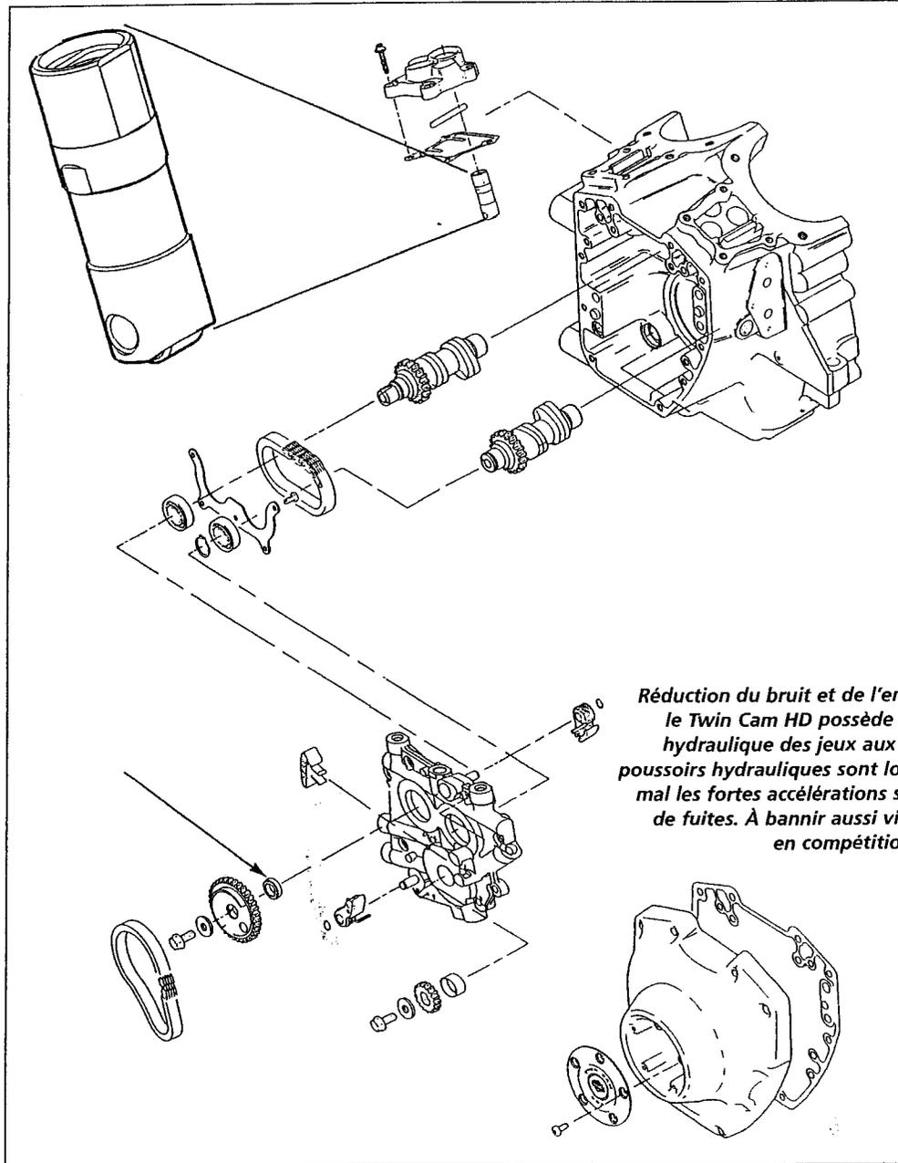
Réduction du bruit et de l'entretien obligent, le Twin Cam HD possède un rattrapage hydraulique des jeux aux soupapes. Les poussoirs hydrauliques sont lourds et supportent mal les fortes accélérations sans un minimum de fuites. À bannir aussi vite que possible en compétition.
