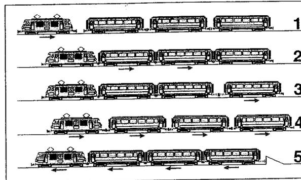
Propagation des trains d'ondes. La comparaison des phénomènes de propagation des ondes avec le comportement d'une locomotive accostant un train permet de bien visualiser le déroulement des événements en fonction de la nature de l'obstacle rencontré.
