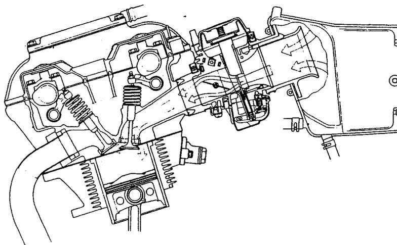
*Sur les sportives, on trouve parfois des linguets. Le réglage du jeu aux soupapes est simplifié par rapport à des pastilles. Le potentiel de ce type de distribution est très élevé en termes d'accélération de soupapes et donc d'efficacité de la loi de levée. En formule 1, on utilise ce type de distribution pour faire tourner les 3,5 l à 17 000 tr/min.*
