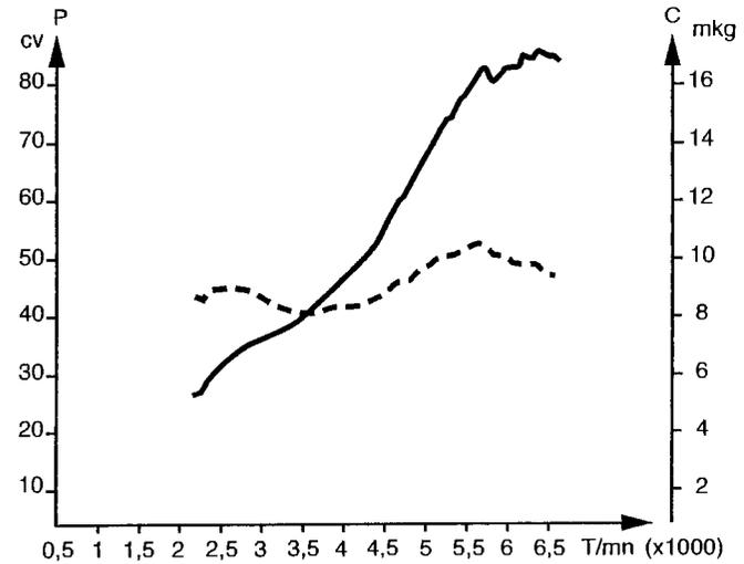
*Courbe de puissance et de couple du 1200 Buell. Avec 8 à 10 m/kg de couple entre 2000 et 6500 tr/min, le twin culbuté deux soupapes offre un légendaire "coup de pied au cul", fabuleux sur la route... Et pas ridicule sur circuit. Si l'on fait abstraction de sa cylindrée, comme en bataille des twins, on dispose d'une base fort plaisante (Source Moto Journal).*
